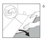
Placez la languette de la première lame de la nouvelle rangée dans la rainure de la lame de la rangée précédente en formant un angle.
