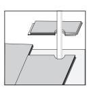
Si les tuyaux traversent le sol, faites un trou d'un diamètre mesurant 10mm de plus que celui du tuyau.
