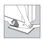
Sciez la chambranle à la hauteur adaptée. Prévoyez 2mm d'espace avec les lames. Si besoin, les lames peuvent être posées à partir de n'importe quelle direction. C'est le moyen de faciliter la planification de la pose, par ex. autour des portes.
