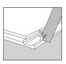
Si à cause d'une chambranle ou d'un radiateur trop bas vous ne pouvez pas clipser la lame, nous vous proposons la solution indiquée dans l'image. Ôtez le bord (ou) servant au verrouillage.
