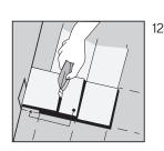
La dernière et la première lames doivent être coupées à la bonne largeur. Placez la lame au-dessus de l'avant-dernière lame.
